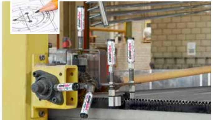
El lubricador simalube de 15 ml que incorpora un cepillo abastece constantemente con aceite la cremallera de una máquina de carga. Otros lubricadores simalube de 15 ml lubrican el soporte de brida con grasa.
