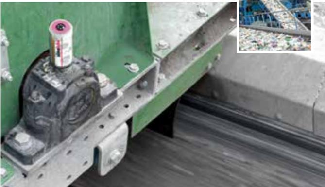
Un simalube de 125 ml lubrica el rodamiento de una cinta transportadora.
