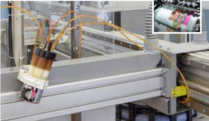
Un simalube multipunto lubrica 5 guías lineales en una cortadora y una apiladora de papel de una imprenta.
