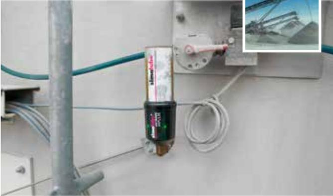
En una obra de grava se aplica simalube IMPULSE con un lubricador de 125 ml. IMPULSE presiona el lubricante con 10 bares a través de un conducto de 4 metros de longitud.
