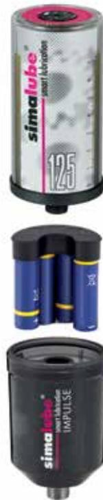
Instale simalube IMPULSE. Coloque el bloque de pilas, enrosque el lubricador simalube y ajuste el tiempo de funcionamiento.
