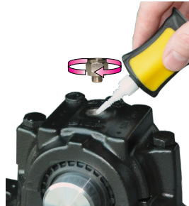
Reduziernippel einschrauben (wenn nötig, Schmierstelle abdichten)
