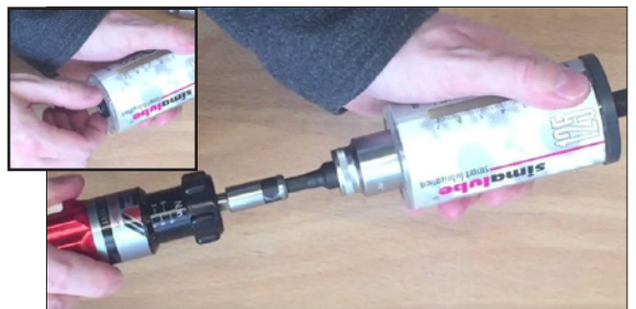
Antriebskopf einschrauben und mit 1,5-2,0 Nm festziehen
