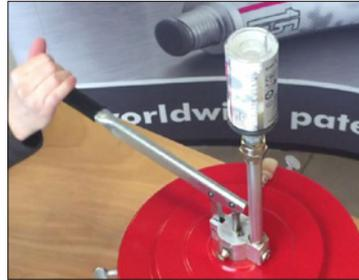
Coloque el simalube en el engrasador y presione la grasa hasta la marca superior. **⚠ NO LLENE DEMASIADO!**
