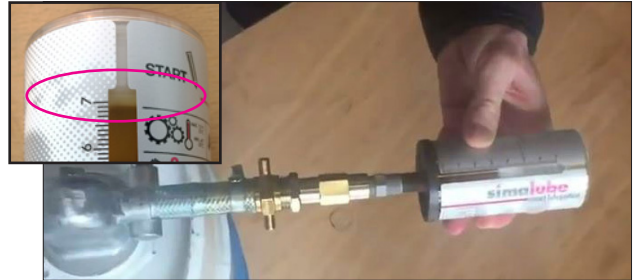
Coloque el simalube en el engrasador y bombee aceite hasta la marca superior. ⚠ NO LLENE DEMASIADO!
