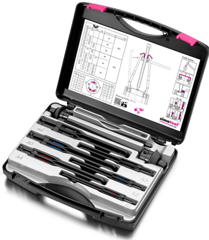
El juego de herramientas de desmontaje BP 61 permite quitar el rodamiento rígido de bolas del eje. Es posible desmontar también rodamientos sellados después de haber quitado la junta correspondiente. Los dedos de las patas extractoras se colocan en la pista de rodadura del anillo exterior. Es adecuado para el desmontaje de 61 rodamientos rígidos de bolas diferentes con diámetros de agujero de 10 a 100 mm.
