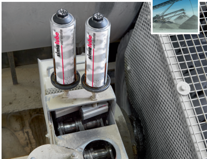
2个250ml司马泰克自动润滑器和毛刷用来清洁和润滑驱动链条
