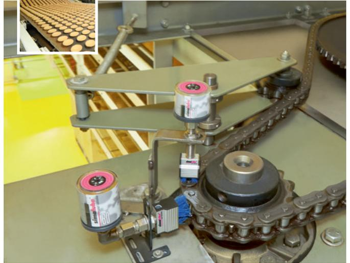
La chaîne d'entraînement d'un tapis de transport, qui sert à faire refroidir les petits pains, est nettoyée et lubrifiée avec des brosses spéciales bleues et 2 simalube SL18 en taille 30 et 60 ml.
