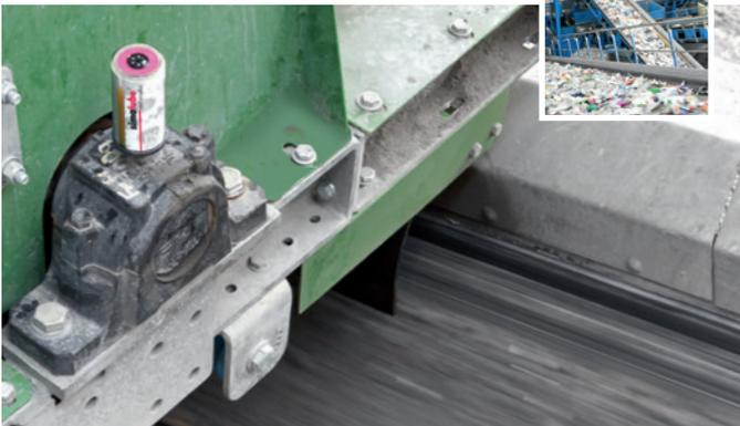
Un simalube 125 ml lubrifie un palier d'une bande transporteuse.
