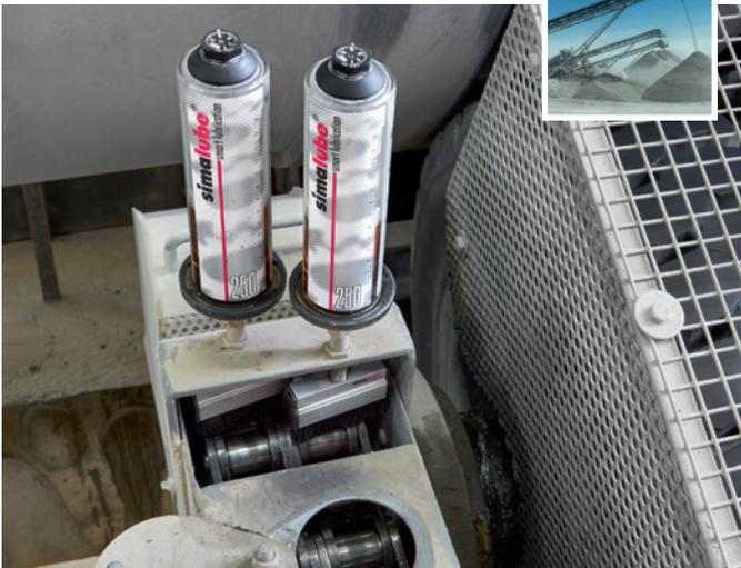
Deux graisseurs simalube 250 ml, montés sur brosses, nettoient et lubrifient la chaîne d'entraînement d'un tambour de lavage
