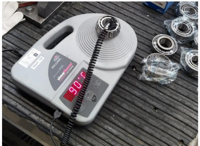
Das tragbare VOLCANO IH 025 im Einsatz für die Montage von Getriebewellen. Dazu wird mithilfe der Temperaturüberwachung ein Kegelrollenlager auf die gewünschte Temperatur erwärmt.
