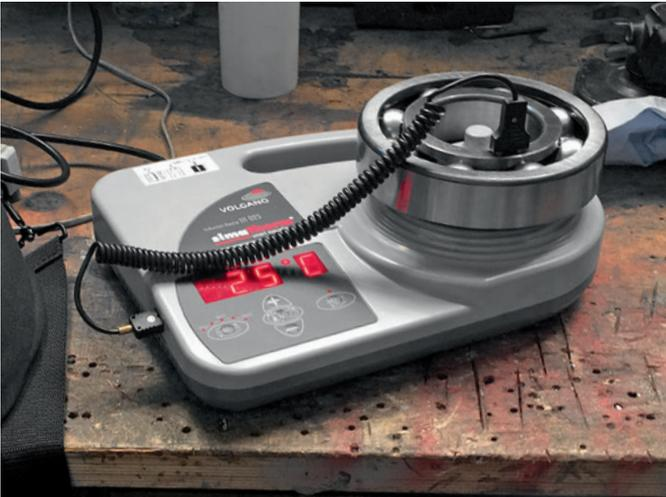
Das tragbare Anwärmgerät VOLCANO IH 025 wiegt nur 3,5 kg und kann ohne Probleme Werkstücke bis 10 kg anwärmen.
