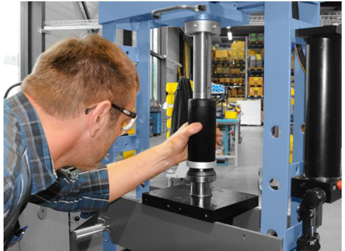
Das FT-P ist die ideale Lösung bei Montagen mit grösseren Einbaukräften, da das Werkzeug auf Pressen eingesetzt werden kann. Hochwertige Aluminiumringe, die sich auch bei Einpresskräften von 5 Tonnen nicht verformen.
