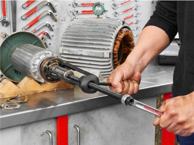
Der Twin Puller TP 150 schafft's: Ein feststehendes Lager eines Elektromotors wird ohne Beschädigung der Welle demontiert.
