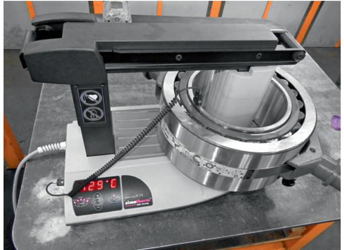
Mittels Induktion wird das auf der Spule liegende Pendelrollenlager mit dem simatherm Anwärmgerät IH 210 angewärmt. Ist die vorgegebene Montagetemperatur erreicht, wird das Lager mit dem simatool Bearing Handling Tool auf die Welle montiert.
