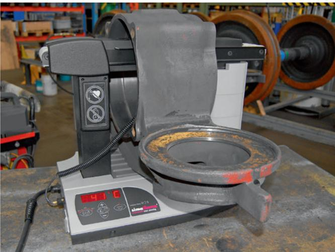
Für Arbeiten an einem Eisenbahnradsatz wird mit dem leistungsstarken Anwärmgerät IH 210 ein massives Lagergehäuse angewärmt.
