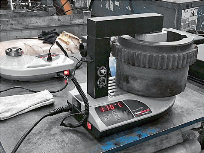
Die simatherm Geräte VOLCANO IH 025 und IH 070 mit zwei unterschiedlich grossen Anwärmteilen: Das Modell IH 070 (im Vordergrund) wärmt eine Zahnradhülse auf die vorgegebene Montage-temperatur an.
