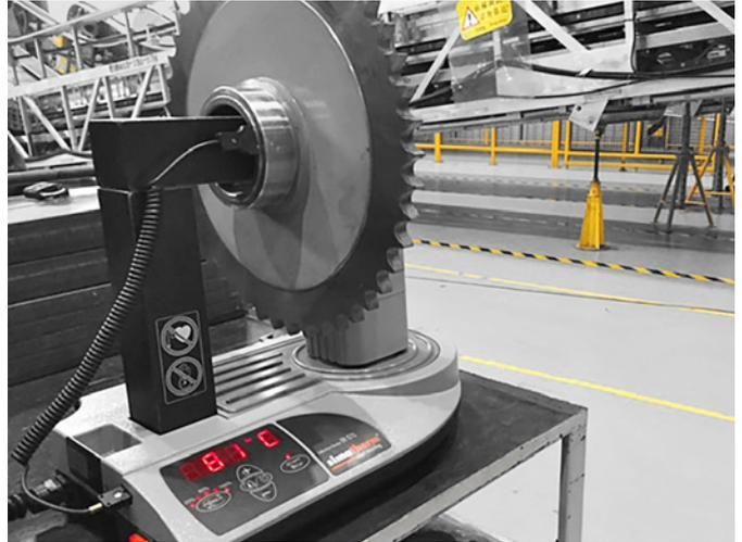
Das Anwärmgerät IH 070 leistet beim Anwärmen eines Umlenkritzels für die Stufenkette einer Fahrtreppe wertvolle Dienste.
