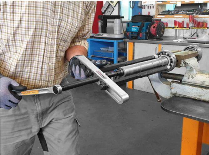
Der Ausbauerwerkzeugsatz BP 160 ermöglicht mithilfe von Verlängerungen auch die Möglichkeit, schwer erreichbare Lager einfach und fachgerecht auszubauen.
