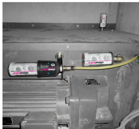
油脂可經漫長的管道注入潤滑點, 並以帶2個磁鐵的安裝支架把小保姆智能藍牙增壓泵穩固在設備上
