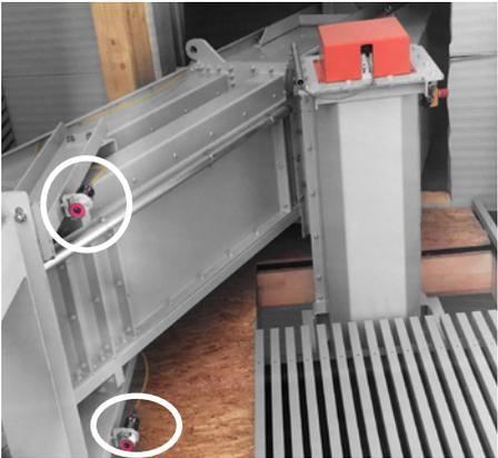
在鋸木廠案例中, 鏈式輸送帶的軸承位於難於接近的高度, 但藉助藍牙®連接小保姆智能藍牙增壓泵, 就可瞭如指掌的監控潤滑工況
