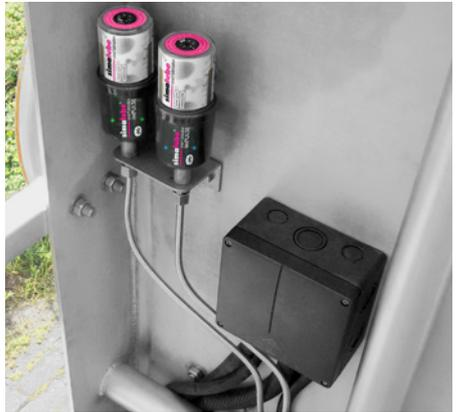
由於在泳池清潔器上安裝了不可拆的長管道, 因此使用2個小保姆智能藍牙增壓泵就克服了背壓並確保持續潤滑
