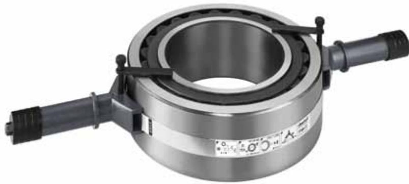
La herramienta Bearing Handling Tool es ideal para levantar rodamientos grandes y pesados de forma profesional y segura. Con la herramienta BHT se reduce el riesgo de accidentes y de daños en el rodamiento. La herramienta BHT rodea el anillo exterior del rodamiento con una abrazadera de acero. Las dos asas opuestas y los dos arneses permiten la manipulación sencilla con una grúa. El orificio permanece libre, de manera que el rodamiento se puede empujar sobre un eje con facilidad.
