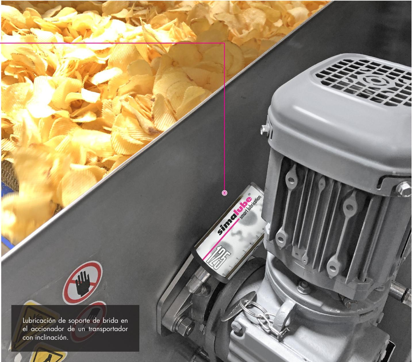
Lubricación de soporte de brida en el accionador de un transportador con inclinación.
