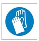
Protección de las manos Utilizar quantes adecuados ensayados según la norma EN 374. Goma de nitrilo.
