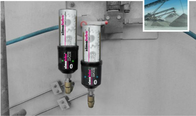
Der simalube IMPULSE connect mit 125 ml Schmierstoff wird in Kieswerken eingesetzt. Die Geräte werden über die App «simatec world of maintenance» konfiguriert und überwacht.
