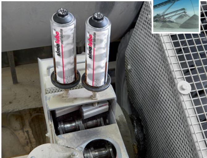
2 simalube Spender 250ml mit Bürsten schmieren und reinigen den Kettenantrieb einer Trommelwaschmaschine.
