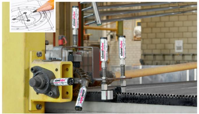
simalube Spender 15 ml mit Bürste versorgen die Zahnstange eines Beschickungsautomaten stetig mit Öl. Weitere simalube Spender 15 ml schmieren das Flanschlager mit Fett.
