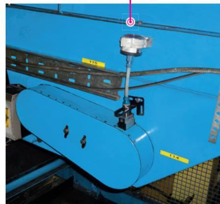
Le tapis roulant destiné aux bagages d'un aéroport est lubrifié automatiquement de l'extérieur. Il n'est donc plus nécessaire de procéder au démontage fastidieux du couvercle de la chaîne.
