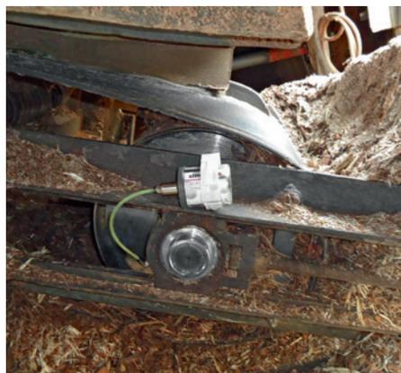
Die Y-Spannlageinheit eines Förderbandes wird kontinuierlich mit Fett versorgt.
