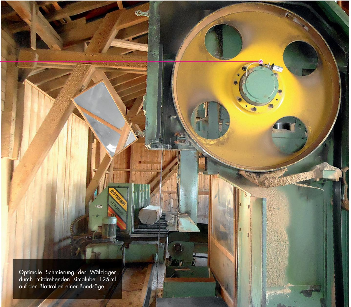
Optimale Schmierung der Wälzlager durch mitdrehenden simalube 125 ml auf den Blattrollen einer Bandsäge.
