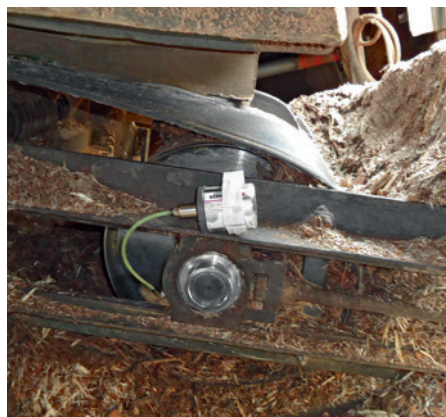
La unidad del cojinete de bolas en Y se abastece continuamente de grasa.
