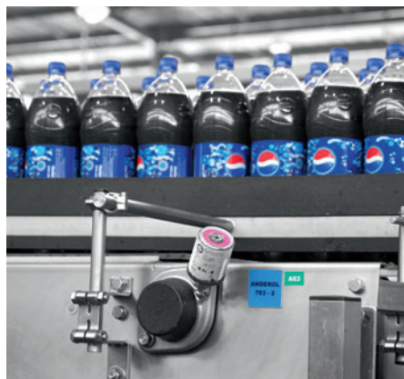
Lubricación de un cojinete con brida en una instalación de llenado para refrescos.
