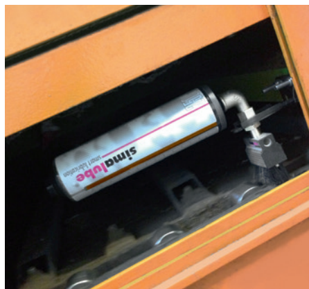
Die Förderkette in einer Recyclingfabrik wird mit simalube und Bürste automatisch geschmiert und gereinigt.
