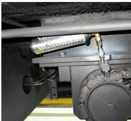
El lubricador simalube 250ml lubrica la cadena de transmisión de un carril de la grúa de construcción. El lubricador está protegido, además, por una capucha protectora.
