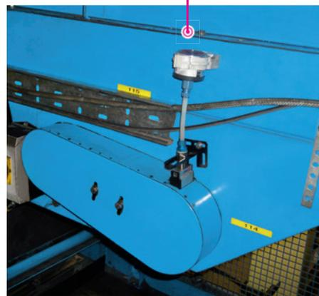
La cinta transportadora de equipajes de un aeropuerto se lubrica automáticamente desde el exterior. Ya no es necesario desinstalar la cubierta de la cadena, que supone un proceso complicado.
