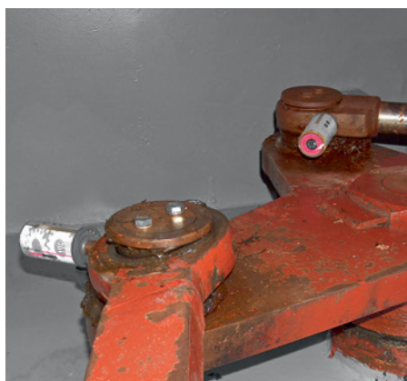
Le gouvernail est lubrifié par deux graisseurs simalube de 125 ml.
