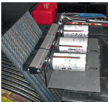
Trois graisseurs simalube de 125 ml avec brosses lubrifient et nettoient les câbles simultanément.
