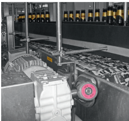
Lubrification du convoyeur à bande avec un graisseur simalube.
