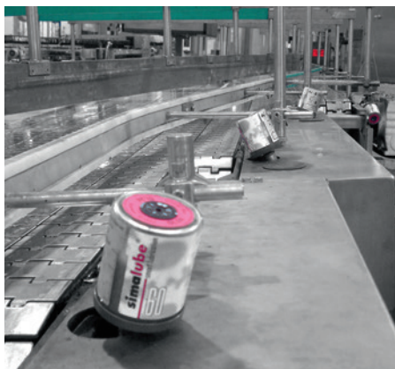
Ligne d'embouteillage dotée de plusieurs graisseurs simalube.
