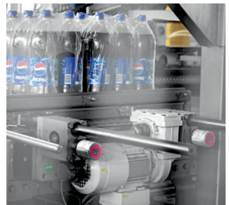
Les paliers de l'engrenage sont lubrifiés avec deux graisseurs simalube de 60 ml.
