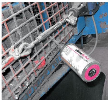
L'installation de simalube à l'extérieur de l'entrepôt garantit la propreté du point de lubrification.
