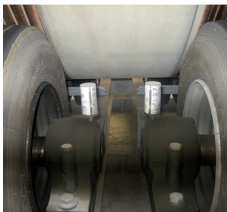
Soportes partidos con rodamiento de rodillos esféricos en el accionamiento de una cinta transportadora. Los lubricadores están atornillados directamente sobre el soporte.
