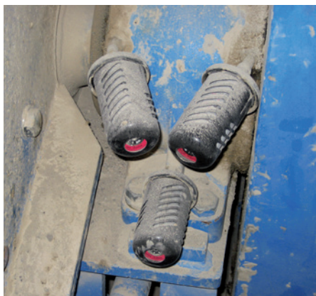
Cubiertas de protección evitan que los lubricadores sean dañados por influencias exteriores.
