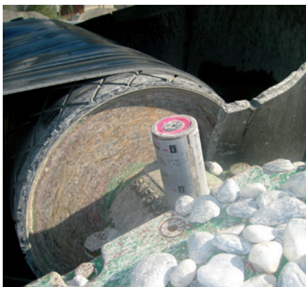
Rodamiento de soporte para accionamiento de banda lubricado con simalube.
