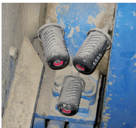
Les capots de protection empêchent les dommages aux graisseurs causés par des facteurs externes.
