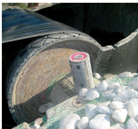
Un entraînement par courroie lubrifié avec simalube.
