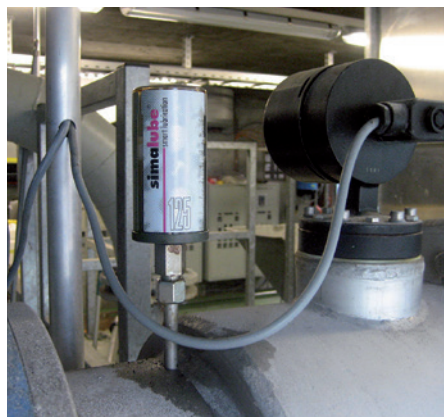
Lubricación de rodamientos: el lubricante se transporta hasta el cojinete a través de un conducto corto
