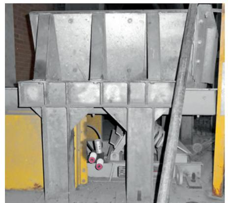
Mehrere 125 ml simalube Schmierstoffspender schmieren den Vibrationsförderer.
