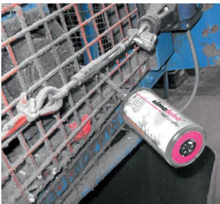
Durch den extern am Lager installierten simalube gelangt kein Schmutz in die Schmierstelle.
