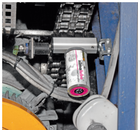
Der simalube Spender versorgt die Kette auch bei engsten Platzverhältnissen kontinuierlich mit Öl. Die Bürste reinigt gleichzeitig die Kette.
