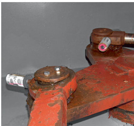
Das Ruderrad wird mit zwei 125 ml simalube geschmiert.
