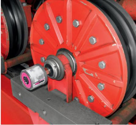
Los rodillos de guía del funicular se abastecen con la lubricación necesaria.
