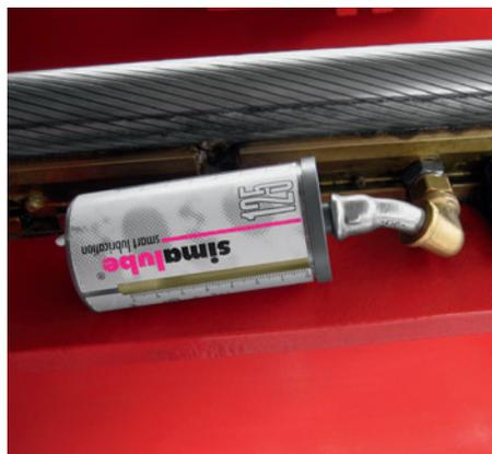
El lubricador automático simalube se instala directamente en la telecabina y abastece una lubricación constante.
