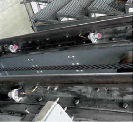
Se han instalado varios lubricadores automáticos en una telecabina. Gracias al montaje de una abrazadera magnética se evitan costosas instalaciones.
