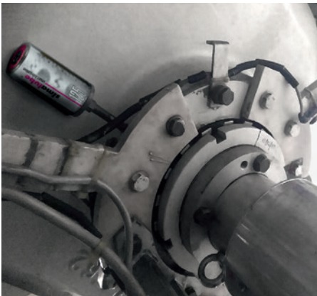
Con los prácticos accesorios simalube se puede equipar cada punto de lubricación con un lubricador simalube.
