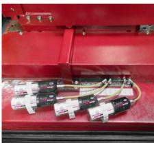
Vier simalube IMPULSE connect Druckverstärker schmieren mittels Schlauchverbindungen die Linearführungen einer CNC-Maschine. Mit der simatec App können die IMPULSE einzeln angesteuert und konfiguriert werden.
