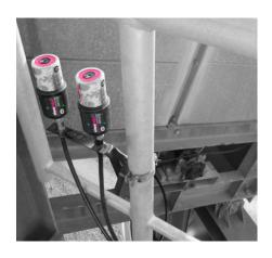
Die Schmierpunkte befinden sich in gefährlicher Höhe. Mit der simatec App können diese praktisch vom Boden aus kontrolliert werden.
