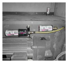
Der Schmierstoff wird über eine lange Leitung zur Schmierstelle geführt. Ein Montagewinkel mit zwei Magneten fixiert den simalube IMPULSE connect an der Anlage.
