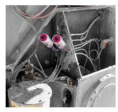
In einem Steinbruch überwinden zwei simalube IMPULSE connect Druckverstärker mühelos den Gegendruck zweier Lager. Zudem wurden diese via simatec App in den simalube Schmierplan «Lubechart» aufgenommen.
