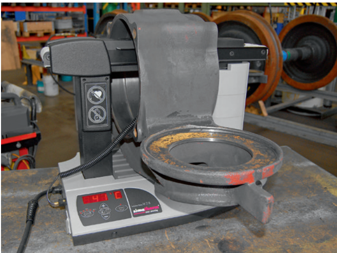
Für Arbeiten an einem Eisenbahnratsatz wird mit dem leistungsstarken Anwärngerät IH 210 ein massives Lagergehäuse angewärmt.
