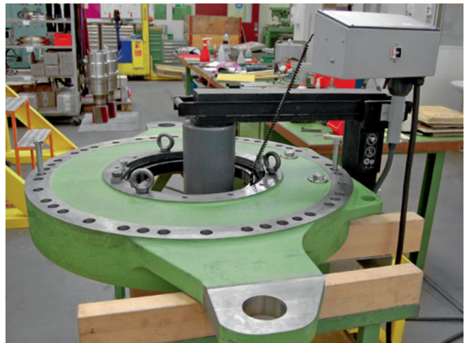
Für das Aufheizen eines Getriebeflanschs einer Windturbine wird das grösste und leistungsstärkste simatherm Anwärngerät IH 240 eingesetzt.
