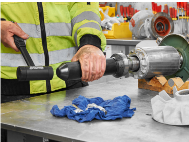
Mit dem Fitting Tool FT 33 werden bei der Montage die Kräfte gleichmässig auf das neue Lager übertragen.
