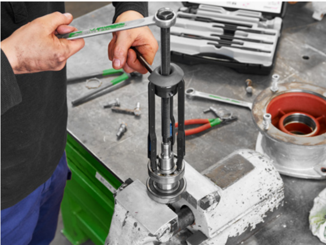
Mit dem simatool Bearing Puller BP 61 lassen sich Kugellager mühelos von Wellen abziehen.
