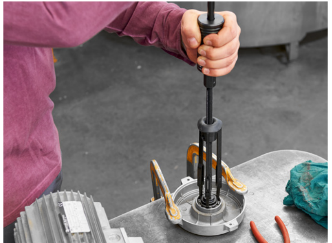
Speditive Demontage eines Lagers aus einem Elektromotor-Deckelgehäuse mit dem Maintenance Kit MK 10-30.
