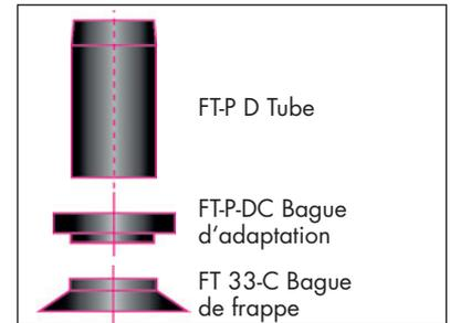
La force d'assemblage maximale avec la presse est de 5 tonnes.
