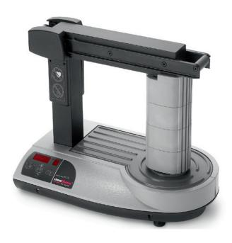
El calentador de inducción simatherm de gran tamaño para rodamientos y otras piezas metálicas redondas con un diámetro de agujero de hasta 640 mm y una sección transversal de 250 x 375 mm. Con la regulación automática del tiempo y la temperatura se pueden calentar rodamientos a la temperatura de 110°C indicada por el fabricante, y otras piezas metálicas redondas hasta 400°C.
