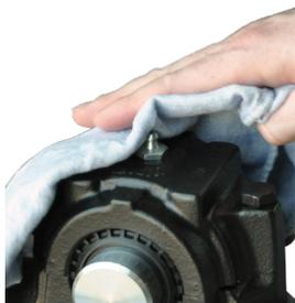
Nettoyage du point de graissage
