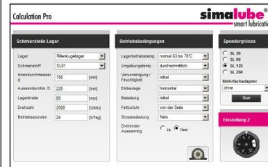
Avec «Calculation Pro»: choisir le lubrifiant, la durée d'utilisation et la taille du graisseur.
