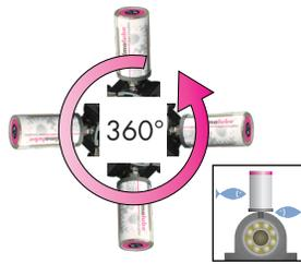
Les graisseurs simalube peuvent être montés dans toutes les positions, même sous l'eau.
