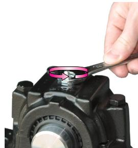
Retrait du raccord de graissage
