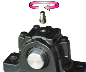
Retire la boquilla de engrase y atornille la conexión de empuje
