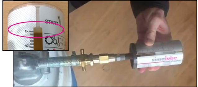
**Placer le simalube sur le raccord et remplir d'huile jusqu'à l'indication supérieure. ⚠ NE PAS SURREPLIR!**
