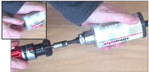
**Visser la tête de commande et serrer avec 1.5 à 2 Nm**
