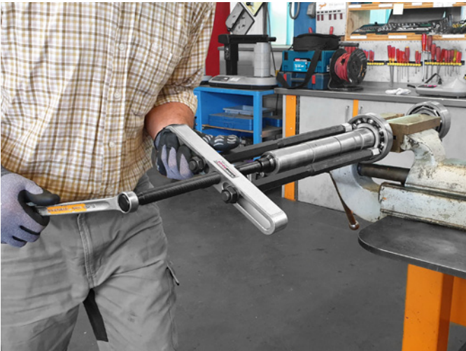
借助延长杆, BP 160拆卸工具还可以轻松、专业地拆卸难以触及的轴承。
