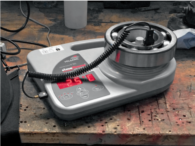
便携式IH 025 VOLCANO加热器重量仅为3.5 kg，但可轻松将重量高达10 kg的工件加热至110°C。
