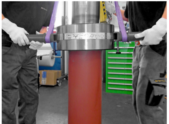
轴承夹持工具BHT能够将沉重、预加热过的滚动轴承安全地提升并精确地定位到涡轮轴上
