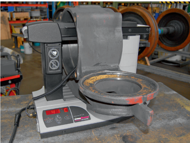
高性能的电磁感应加热器IH 210用于大量火车轮对中轴承箱的加热工作来使得轴承可以被嵌入其中。
