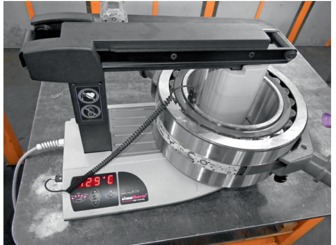
放置在IH 210线圈周围的滚动轴承正在被电磁感应加热。一旦设定的安装温度到达，使用轴承上的司马夹持工具可以轻松移动调整轴承在轴上的位置。
