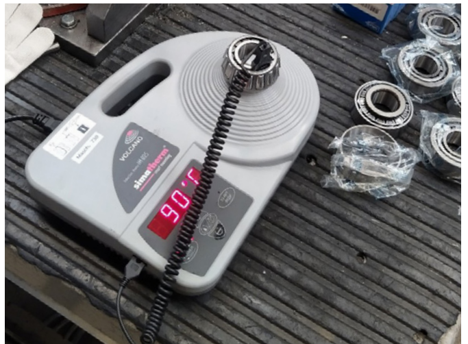
便携式IH 025 VOLCANO加热器用于安装齿轮轴。为此，加热器温度监测系统将圆锥滚子轴承加热至所需温度。
