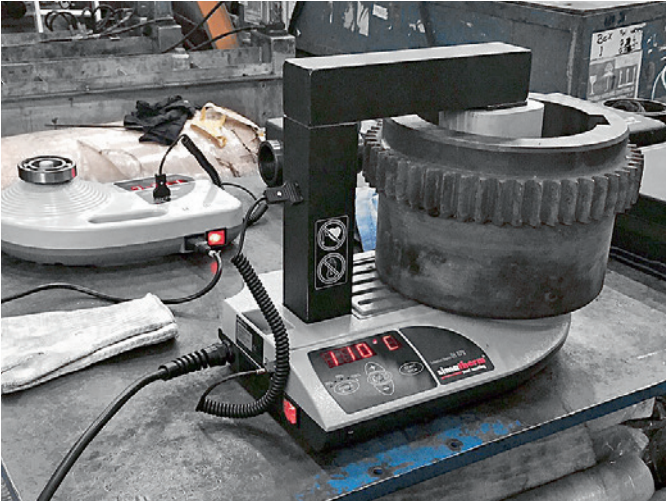
司马电磁感应加热器VOLCANO IH025和IH070加热两种不同尺寸的工件：型号IH070（前方）加热一个齿轮套到特定的安装温度。
