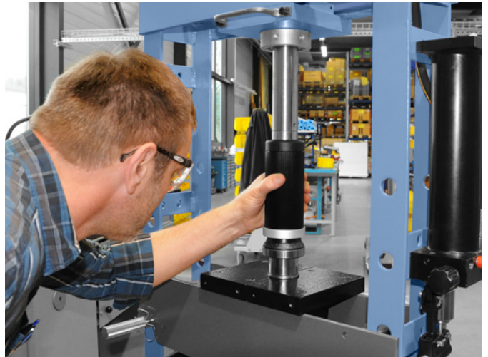
FT-P是安装压力更大的装置的理想解决方案, 因为该工具可以在压力机上使用。高品质铝环, 即使在5吨的压入力下也不会变形。
