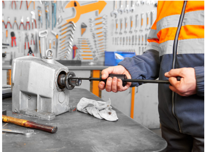
诀窍: 使用密封件拆卸器SP 50从齿轮箱上拆卸径向密封件, 不会伤害外壳或轴
