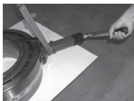
Utilisez les deux poignées afin de resserrer les rubans d’acier uniformément. Vérifiez que les rubans s’agrippent au roulement de manière sûre. Utilisez une clé dynamométrique afin de vérifier que le couple de serrage soit correctement situé entre 14 et 20 Nm. Il est facile d’atteindre les 14 Nm en appliquant une force de 5 kg sur l’extrémité d’une clé de serrage de 30 cm.
