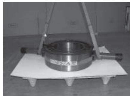
Die Tragriemenlänge (L) muss mindestens 1,5 Mal dem Lagerdurchmesser (D) entsprechen.
