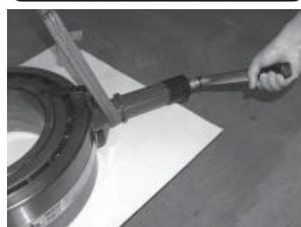
Bei einigen Lagern muss der Innenring blockiert werden um ein Rotieren zu verhindern. Dies gilt für Pendelrollenlager. Dazu werden die Innenringhalter gelockert und gegen den Innenring des Lagers platziert. Nach korrekter Positionierung müssen die Innenringhalter wieder festgezogen werden.
