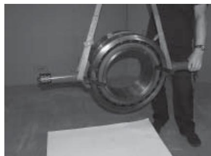
Les poignées sont également utilisées en tant qu'axe de rotation pour passer le roulement de position horizontale en position verticale et vice versa.
