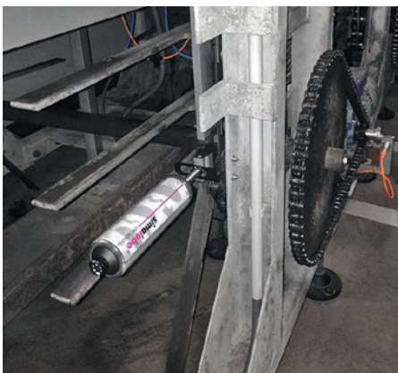
Lubricación de cadenas con un simalube de 250ml y un cepillo plano.
