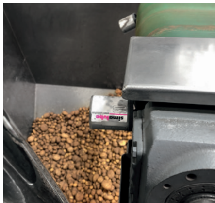
Dos simalube de 60ml lubrican los rodamientos de las poleas de inversión de una cinta transportadora en el procesamiento de las patatas.
