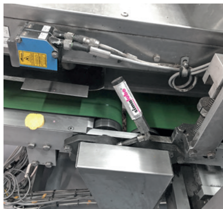
Lubricación de rodamientos del rodillo de accionamiento de una cinta transportadora en la producción de patatas fritas.
