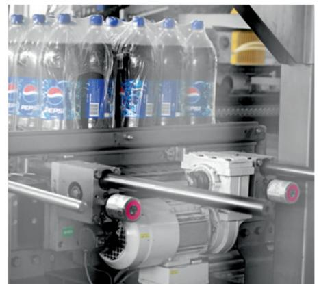
Los cojinetes del reductor se lubrican con dos lubricadores simalube de 60 ml.
