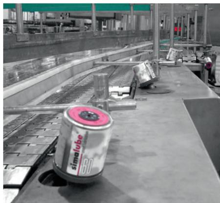
Pista de relleno equipada con varios lubricadores simalube.
