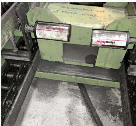
Los lubricadores de simalube incluidos los cepillos están montados en un transportador de cadena. Las cadenas se lubrican de forma continua y se limpian simultáneamente.
