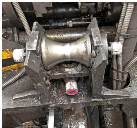
El dosificador simalube de 30 ml lubrica los rodamientos laterales, así como el dispositivo de elevación del rodillo de guía.
