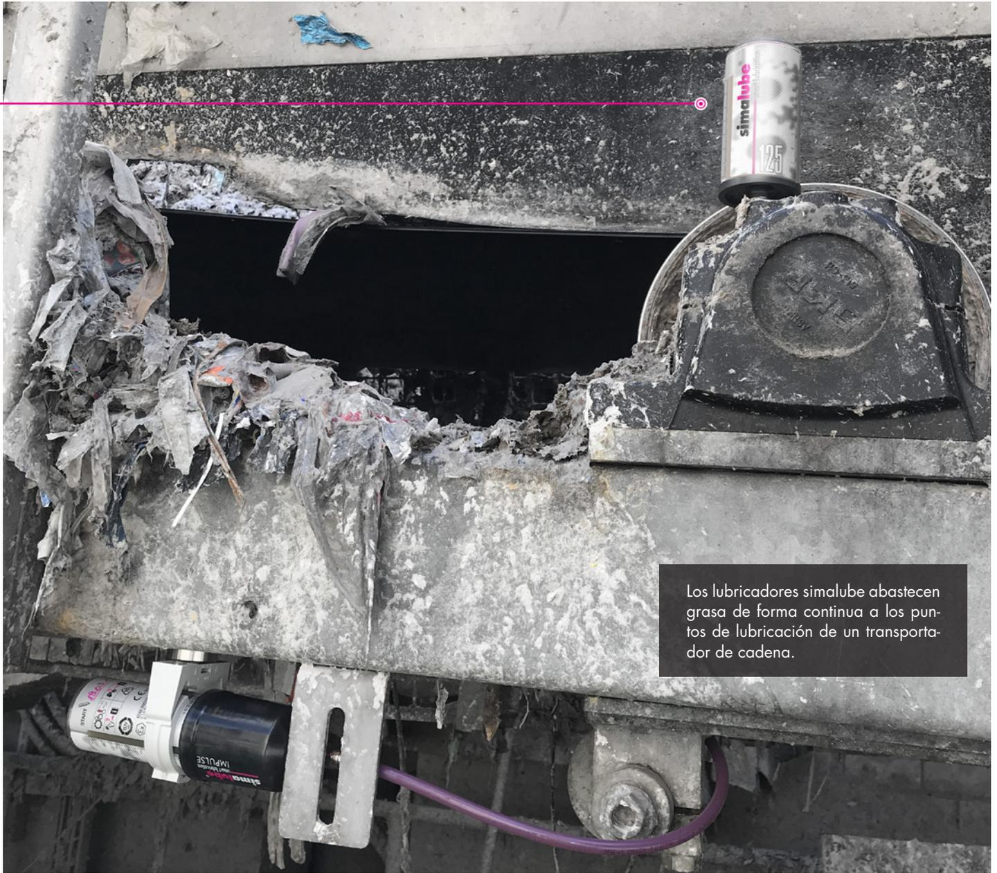
Los lubricadores simalube abastecen grasa de forma continua a los puntos de lubricación de un transportador de cadena.
