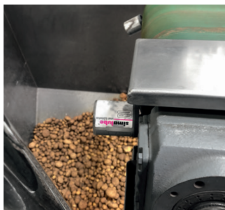
Deux simalube de 60ml lubrifient les roulements de la poulie de renvoi d'un tapis roulant dans la transformation des pommes de terre.
