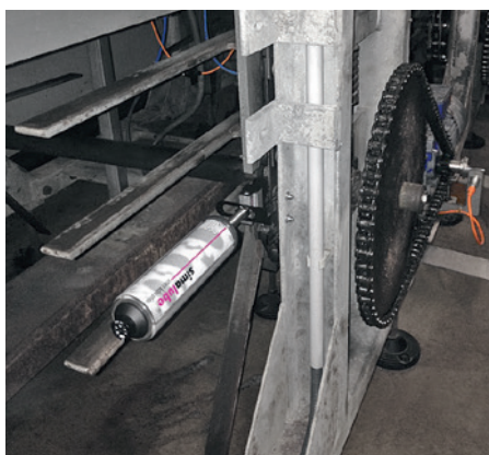
Lubrification de chaînes avec un simalube 250ml et une brosse plate.
