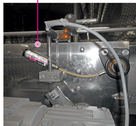
Lubrification de paliers à bride avec un simalube 15ml, le plus petit graisseur au monde.
