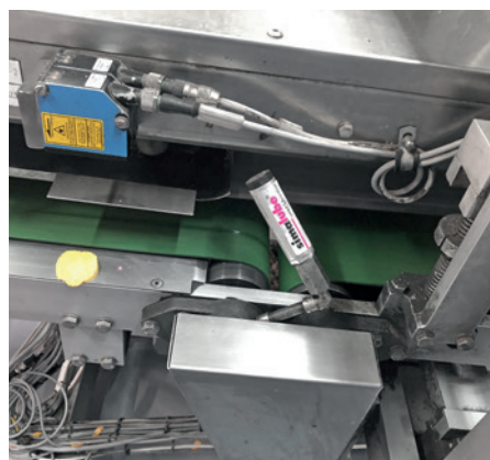
Lubrification des roulements du cylindre d'entraînement d'un tapis roulant dans la fabrication de chips.
