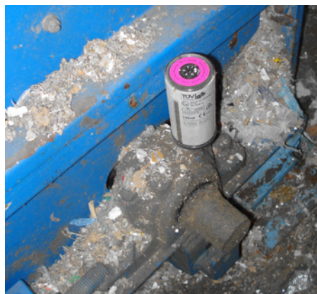
Dans les usines de papier, les paliers d'un broyeur sont lubrifiés avec un simalube 125 ml.
