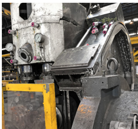
Plusieurs graisseurs simalube et amplificateurs de pression IMPULSES lubrifient les colonnes (à gauche) et l'entraînement (à droite) de la grignoteuse.
