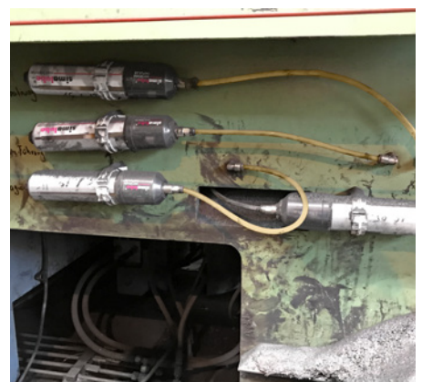
Grâce à l'amplificateur de pression simalube IMPULSE, les points de lubrification sur l'enrouleur (paliers, douilles de guidage et pignons) peuvent être montés séparément et alimentés en lubrifiant via une installation déportée.
