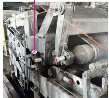
Mehrere simalube 125 ml schmiern die Lager einer Papiermaschine automatisch und punktgenau.
