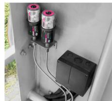
Se utilizan dos simalube IMPULSE connect debido a las líneas de lubricación instaladas permanentemente en un rascador para piscinas. Superan la contrapresión y aseguran una lubricación continua.
