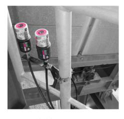
Los puntos de lubricación se encuentran a una altura peligrosa. Con la aplicación simatec estos puntos se pueden controlar cómodamente desde el suelo.
