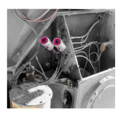
En una cantera, dos amplificadores de presión simalube IMPULSE superan sin esfuerzo la contrapresión de dos rodamientos. Además, estos se han incluido en el programa de lubricación simalube «Lubechart» a través de la aplicación simatec.
