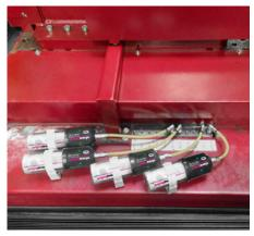
Cuatro amplificadores de presión simalube IMPULSE lubrican las guías lineares de una máquina CNC mediante conexiones de manguera. Con la aplicación simatec se pueden controlar y configurar los IMPULSE individuales.
