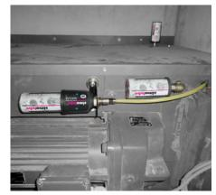
El lubricante se suministra al punto de lubricación a través de un conducto largo. Un ángulo de montaje con dos imanes fija el simalube IMPULSE connect a la instalación.
