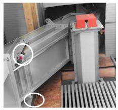
Dans une scierie, les paliers d'un convoyeur à chaîne se trouvent à une hauteur inaccessible. Grâce à la connexion Bluetooth® au simalube IMPULSE connect, ces derniers peuvent être surveillés de manière pratique.
